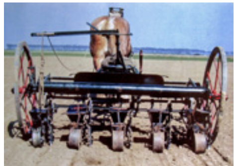
16. De eerste mechanisatie van het zaaien; de nokkenrad-zaaimachine getrokken door een paard. (Bron: IRS)
